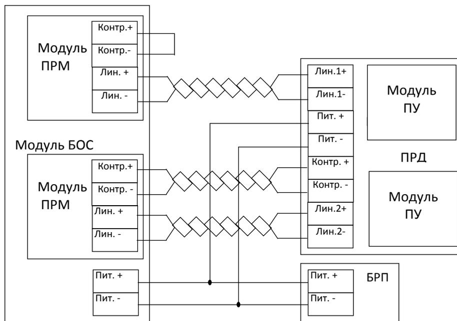
Рисунок 2.12 Схема подключения ПРД к приёмникам ПРМ.
