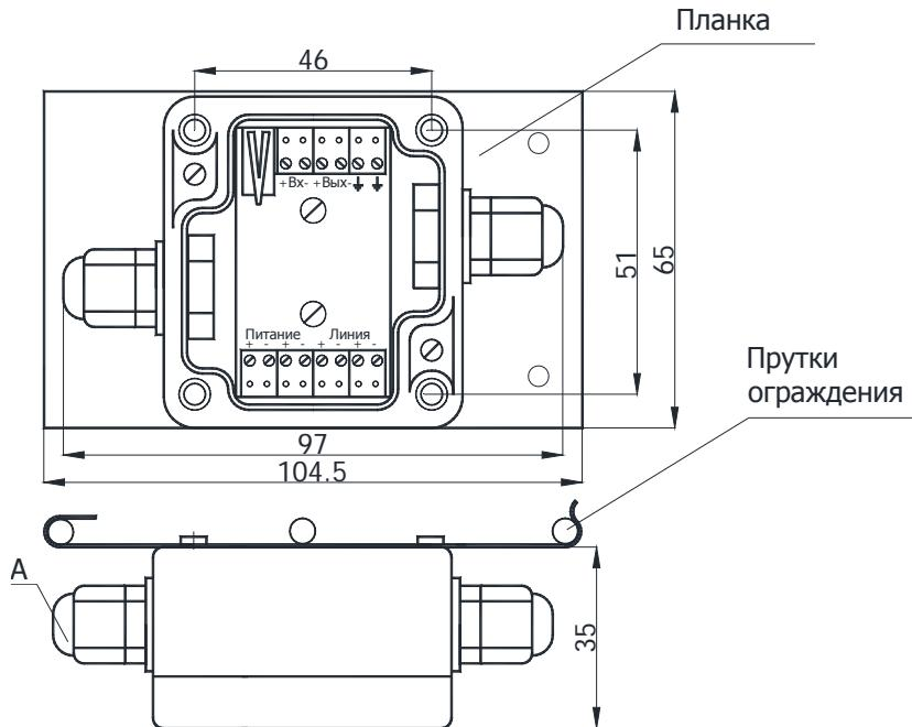
Рисунок 2.8 Общий вид ВД-2.1 с монтажной пластиной
