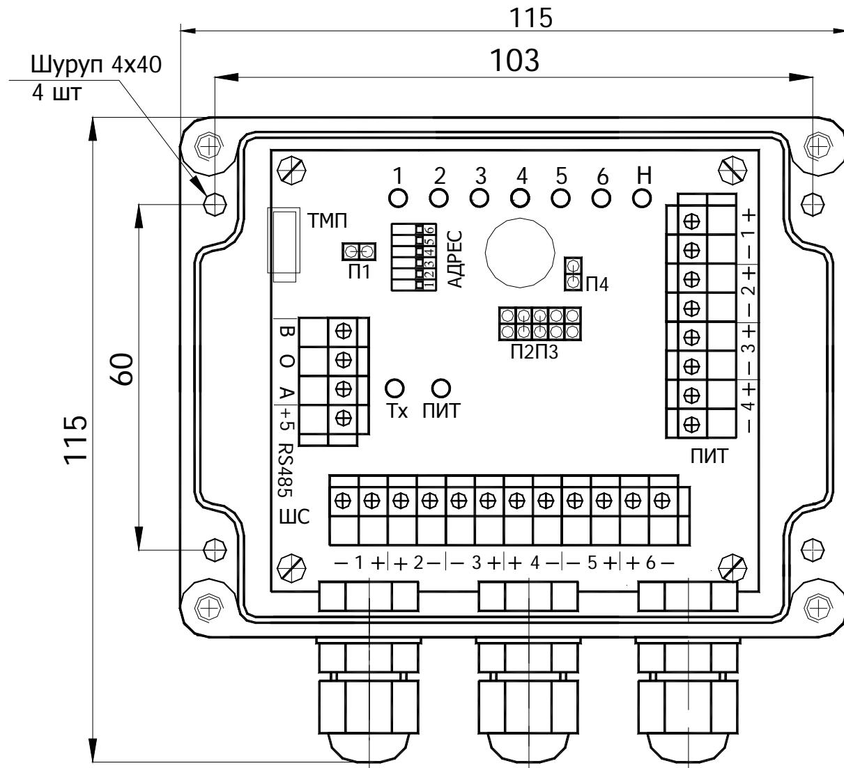
Рисунок 2.15 Общий вид КХ-6 и EX-6 в корпусе
