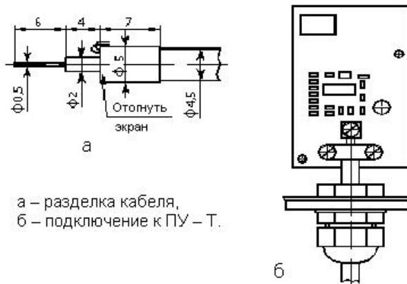
Рисунок 3.11 Подключение ТД-1
