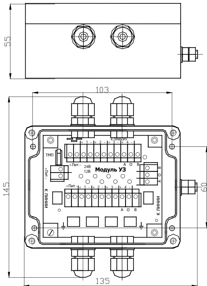
Рисунок 2.13 Общий вид УЗ со снятой крышкой
