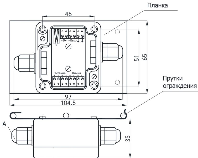
Рисунок 2.8 Общий вид ВД-2.1 с монтажной пластиной
