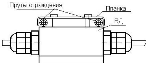
Рисунок 3.10. Способ установки ВД-2 на сетчатых ограждениях (вид сверху).
