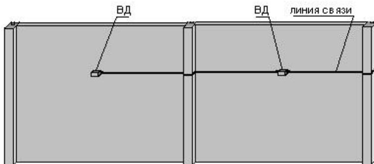
Рисунок 3.9. Способ установки ВД на жёстких ограждениях
