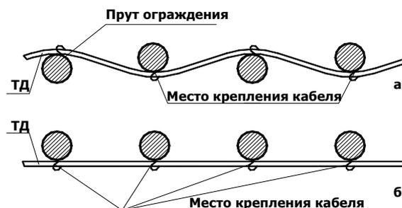
Рисунок 3.7 Способы крепления ТД к сетчатым ограждениям
