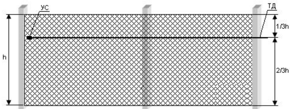
Рисунок 3.1 Способ прокладки ТД для мягких ограждений
