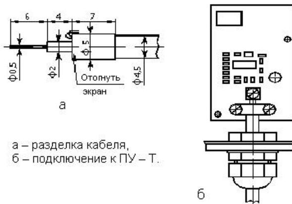
Рисунок 3.11 Подключение ТД-1
