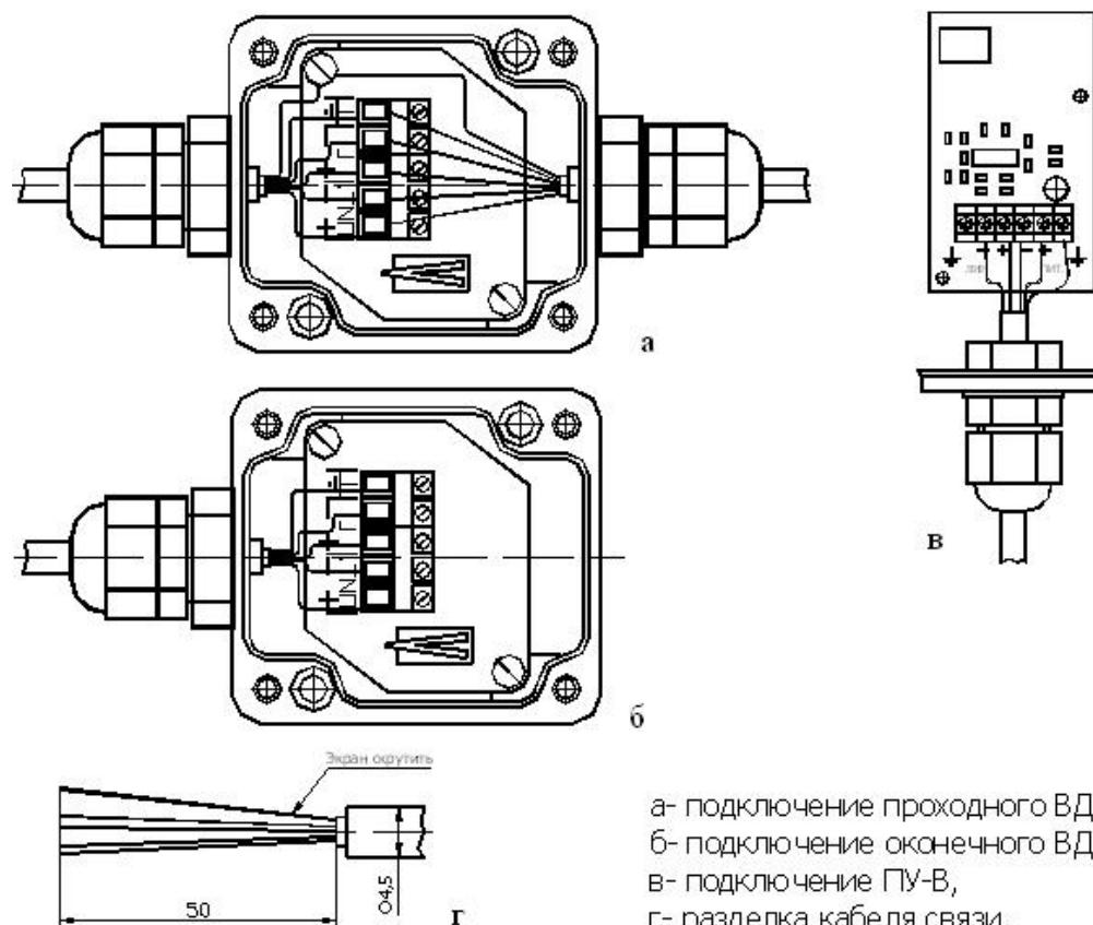
Рисунок 3.13. Подключение ВД-2
