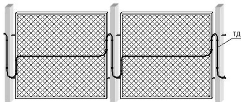
Рисунок 3.4 Способ прокладки ТД для секционных ограждений
