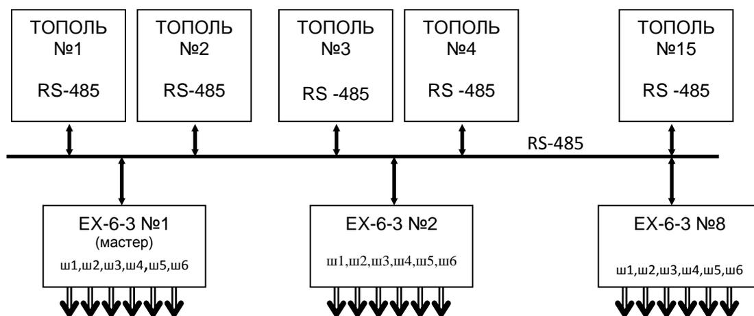
Рисунок 2.16 Структурная схема системы передачи извещений с использованием EX-6-3.
