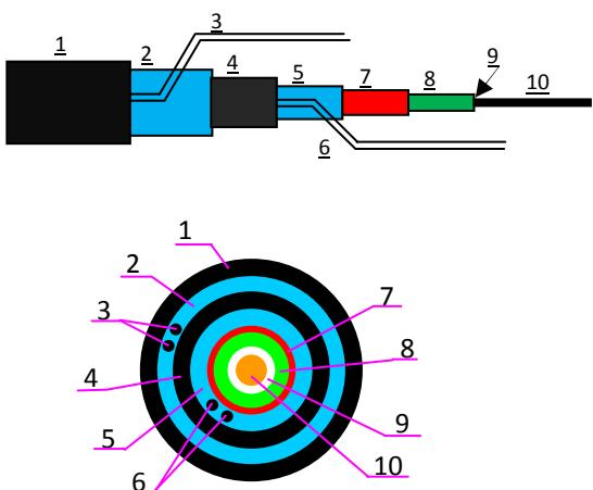
1. Наружная изоляция из уплотнённого полиэтилена стойкого к различным внешним воздействиям, включая УФ излучение.
