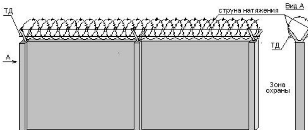
Рисунок 3.6 Способ прокладки ТД по гибким дополнительным заграждениям над жёсткими монолитными ограждениями
