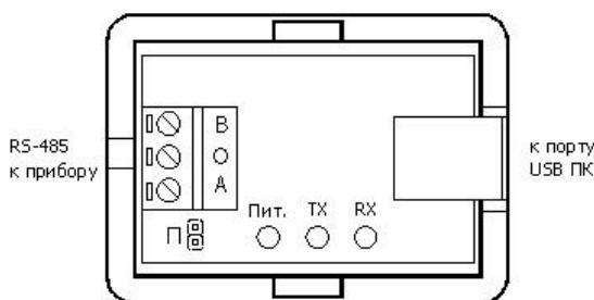
Рисунок 2.14 Общий вид конвертера интерфейсов USB/RS-485G
