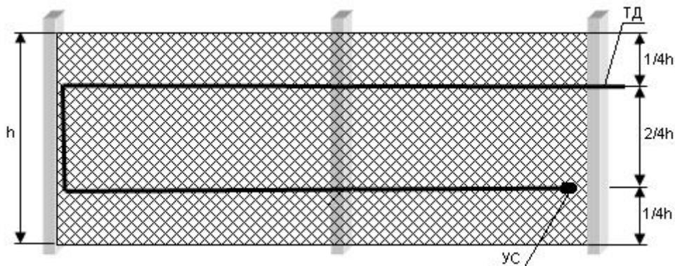
Рисунок 3.2 Способ прокладки ТД для жёстких ограждений
