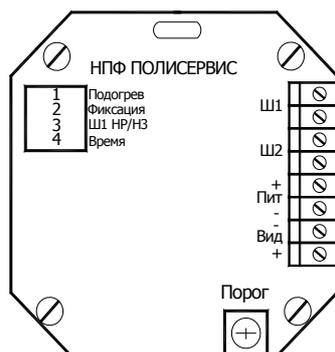
Рисунок 2 Расположение элементов коммутации на плате извещателя
