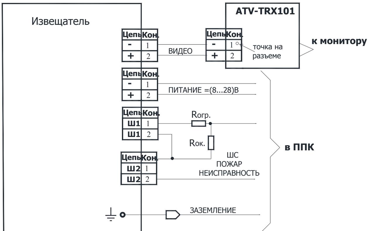
Рисунок 4 Схема подключения извещателя одним шлейфом сигнализации с питанием шлейфа постоянным напряжением. Полярность шлейфов не соблюдается. Оконечный резистор Rок. и ограничительные резисторы Rогр. устанавливаются в соответствии с документацией на ППКП.
