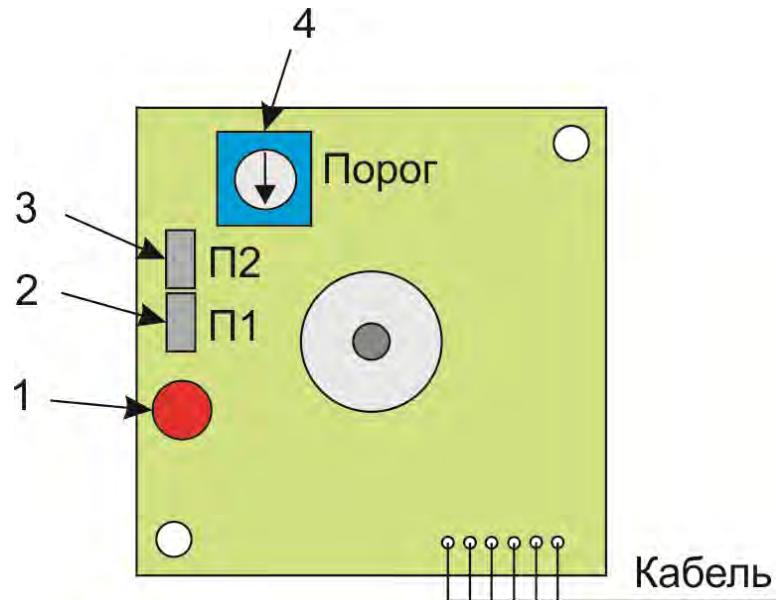
1 – светодиодный индикатор, 2 – перемычка «П1», 3 – перемычка «П2»,
