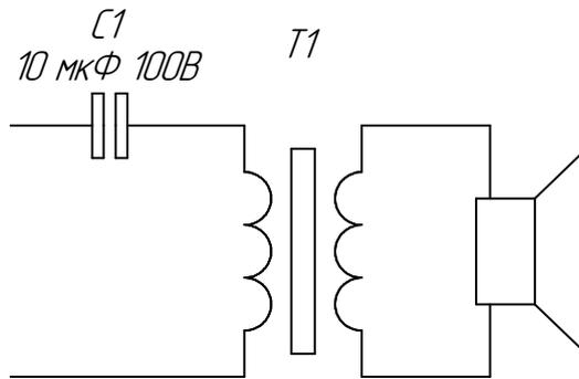
Рисунок 1 Схема АС «Октава»
