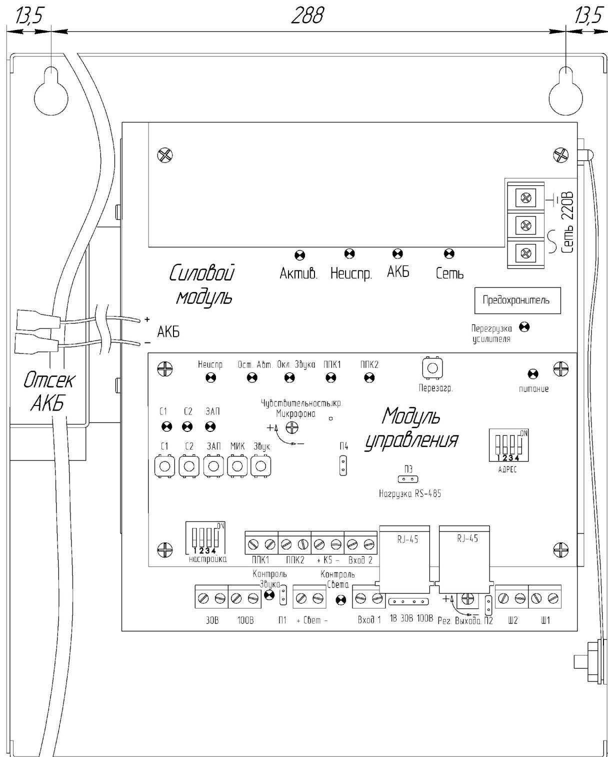
Рисунок 2 Общий вид прибора «Октава-100Ц» снятой крышкой
