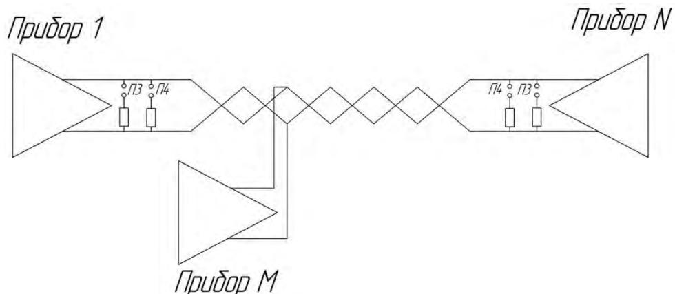
Рисунок 11 Линия связи интерфейса системы оповещения.
