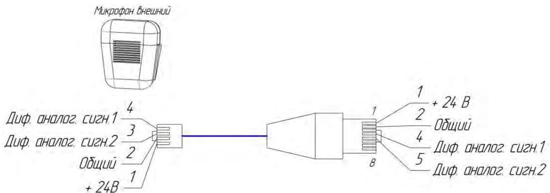
Рисунок 3 Кабель подключения внешнего микрофона ВМ-02
