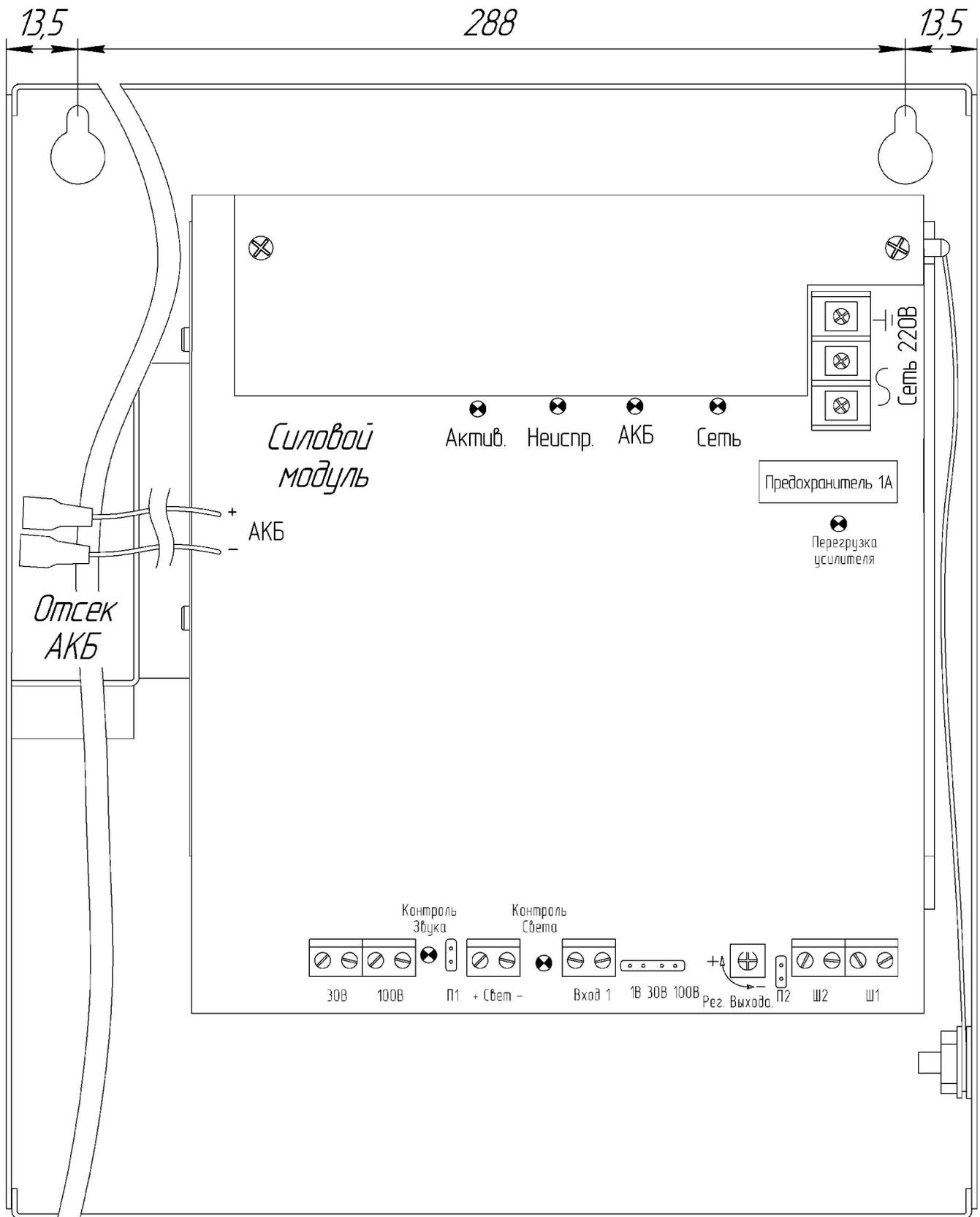
Рисунок 3 Общий вид прибора «Октава-100Б» с снятой крышкой
