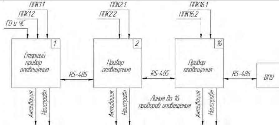
Рисунок 8 Расширенная система оповещения, вариант 1.
