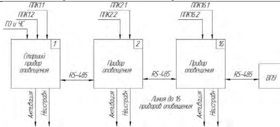
Рисунок 8 Расширенная система оповещения, вариант 1.
