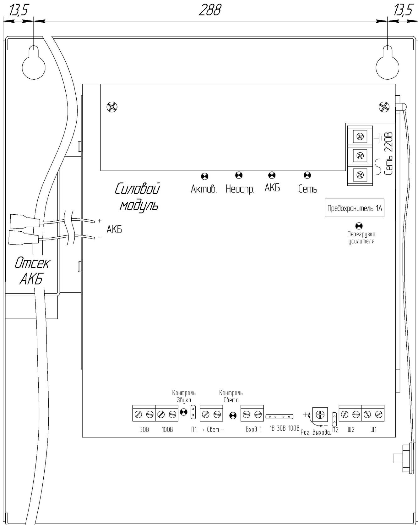
Рисунок 3 Общий вид прибора «Октава-100Б» с снятой крышкой
