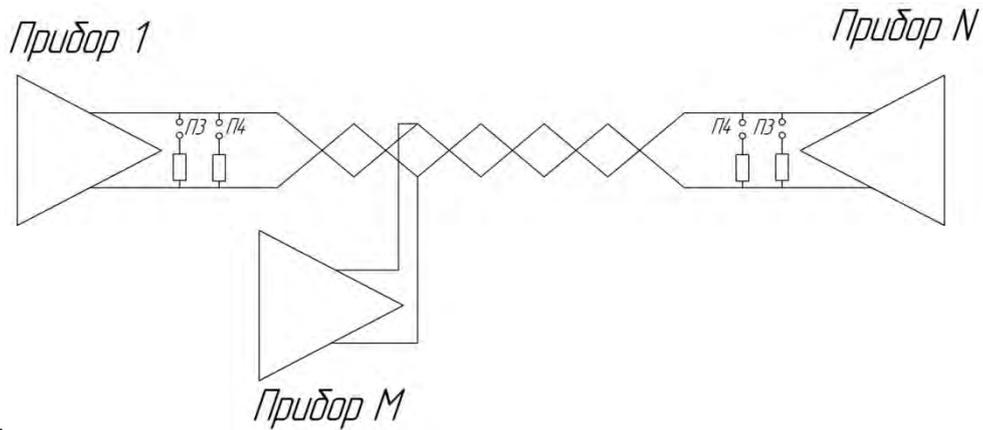
Рисунок 11 Линия связи интерфейса системы оповещения.
