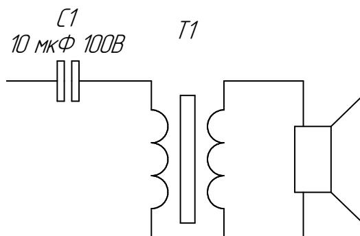
Рисунок 1 Схема АС «Октава»
